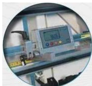
MEDIDOR DIGITAL PARA POSICIÓN HORIZONTAL
